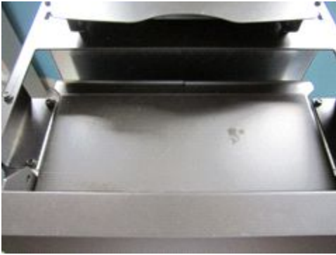
Dessus du poêle avant habillage
