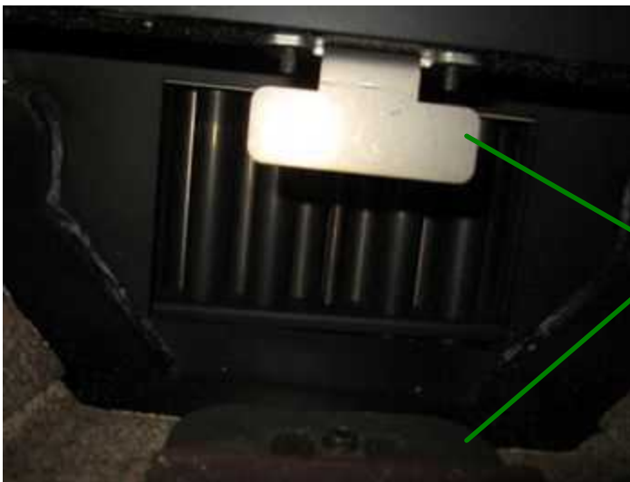
Echangeur thermique vu de l'intérieur du poêle
